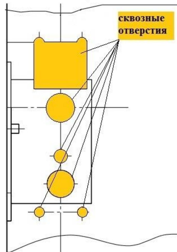
Монтажная схема замка Vonwin 803/823-T/T6 ANSI, все размеры в мм.
