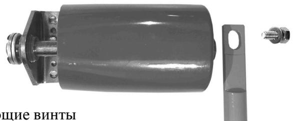
4. Прикрепите корпус доводчика, используя самонарезающие винты с плоской головкой (4 шт) через пластинки, к полотну двери перпендикулярно оси ее вращения, предварительно нагрузив внутреннюю пружину. Для натяжения пружины следует сдвинуть корпус доводчика в сторону от оси кронштейна так, чтобы шток рычага вышел дополнительно из корпуса наружу приблизительно на 5 мм. Установите крышки на торцах корпуса доводчика с обеих сторон для скрытия элементов крепежа.
