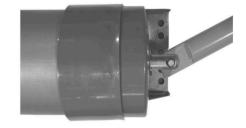
4. Прикрепите корпус доводчика, используя самонарезающие винты с плоской головкой (4 шт) через пластинки, к полотну двери перпендикулярно оси ее вращения, предварительно нагрузив внутреннюю пружину. Для натяжения пружины следует сдвинуть корпус доводчика в сторону от оси кронштейна так, чтобы шток рычага вышел дополнительно из корпуса наружу приблизительно на 5 мм. Установите крышки на торцах корпуса доводчика с обеих сторон для скрытия элементов крепежа.
