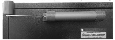
1.Используя размеры,приведенные в таблице для каждой толщины двери, закрепите кронштейн доводчика самонарезающими винтами с потайной головкой(4 шт.) на верхней или боковой планке дверной коробки.Возможно использование дополнительного элемента,закрепленного на дверной коробке, на котором закрепляется кронштейн,например, пластину или уголок.Крепежные элементы входят в состав комплекта доводчика.
